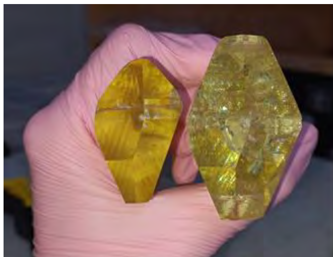
Рис. 1. Монокристаллы \text{Na}_6\text{Mo}_{11}\text{O}_{36} , выращенные методом LTG Cz
